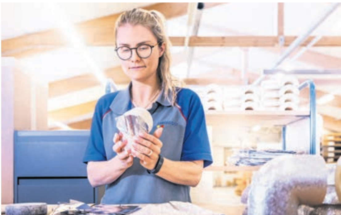
Mit Fingerspitzengefühl werden in Boswil (AG) die swissporKISODUR Bogen von Hand gefertigt.
